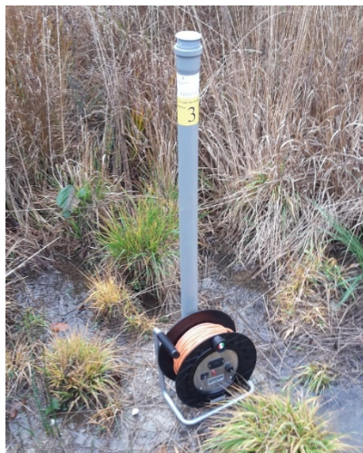
Slika 25: merjenje z elektronskim merilcem vodne gladine
