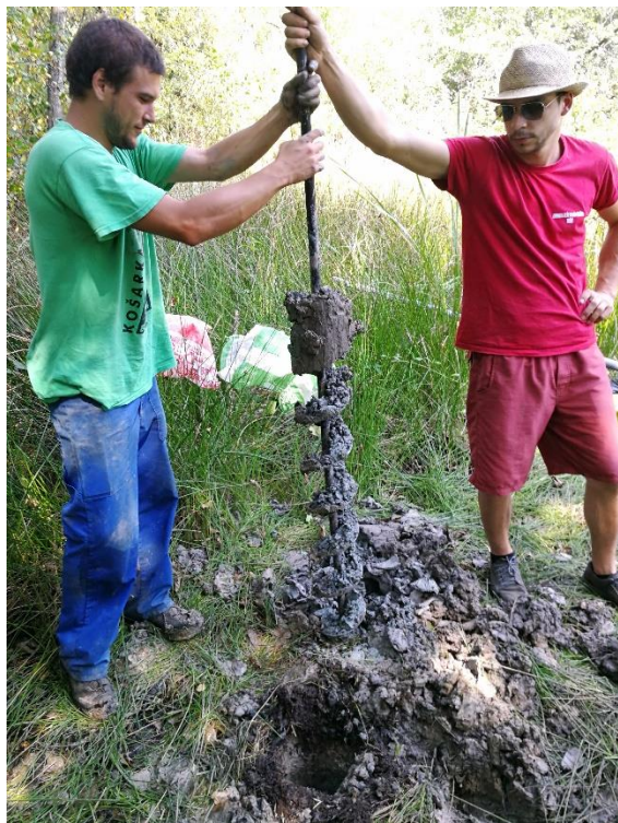
Slika 26.27: Vrtanje ter izvedba piezometra na lokaciji Češeniške gmajne – Dobrava.
