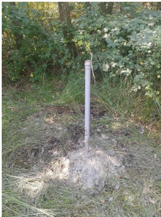
Slika 26.27: Vrtanje ter izvedba piezometra na lokaciji Češeniške gmajne – Dobrava.
