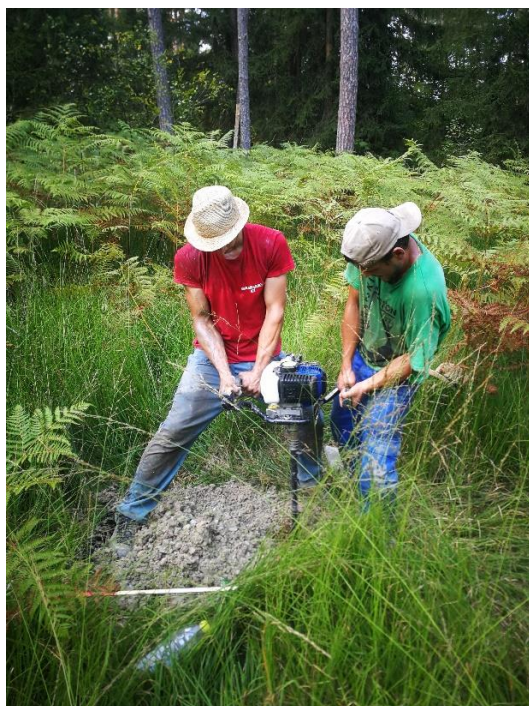
Slika 7,8,9: Vrtanje in izvedba piezometra št. 3, desno glina iz vrtine P5.
