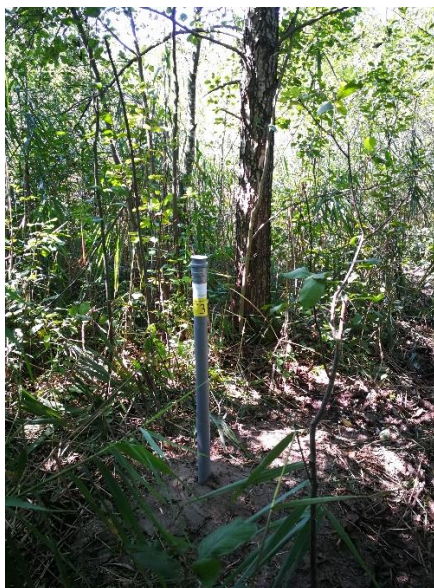
Slika 19,20: Vrtanje ter izvedba piezometra št. 3, na lokaciji Marinčki.
